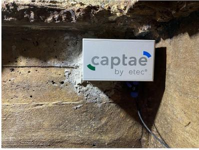
を設置し入水に備えている。毎日目視で亀裂を監視している。昨日、亀裂を記録するキャプチャーを設置した。監視カメラも取り付けた。修理方針が決まるまで監視を強化しているが、絶えず大きな波を受ける場所で亀裂を抱えて不安定なバランスで船が浮いている以上、再沈没のリスクがある。水が深さ50cmのマス目を満たした時、亀裂が今より2cm以上開いた時など、何を基準に緊急事態と認めどのような体制で緊急修理をするかの話し合いが続く。緊急事態の見極めが難しいのはコロナ禍と重なり困難が続く。
